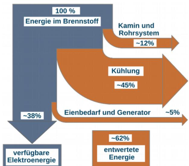
Fig. 7.14: Energieflussschema eines Wärmekraftwerks
