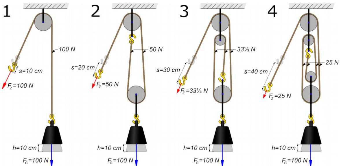
Fig. 5.28: Feste Rolle (1) sowie Flaschenzüge mit zwei (2), drei (3), vier (4) Rollen
