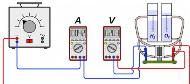
Fig. 7.26: Die Brennstoffzelle funktioniert als Elektrolyseur
