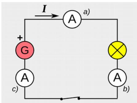
Fig. 6.11: Stromkreis mit Amperemetern
