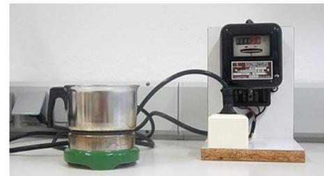
Fig. 7.23: Erwärmen auf der Elektroplatte
