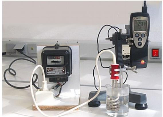
Fig. 7.18: Messung der elektrischen Energie und der Temperatur
