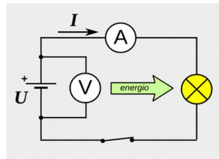
Fig. 6.16: Stromkreis mit Batterie und Lampe
