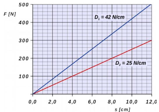
Fig. 2.8: s-f Diagramm für zwei verschiedene Stahlfedern
