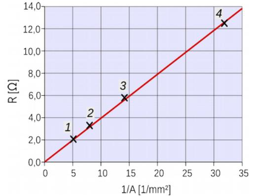
Fig. 6.29: Widerstand von Konstantan-drähten verschiedener Durchmesser
