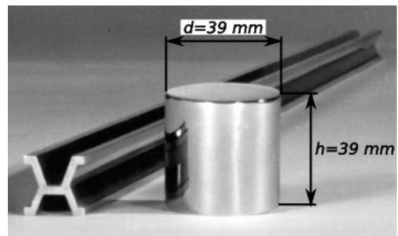
Fig. 1.6: Urmeter und Urkilogramm aus einer Legierung aus 90% Platin und 10% Iridium
