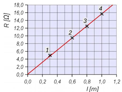
Fig. 6.28: l - R Diagramm für einen Draht aus Konstantan mit  $d = 0,2 \text{ mm}$
