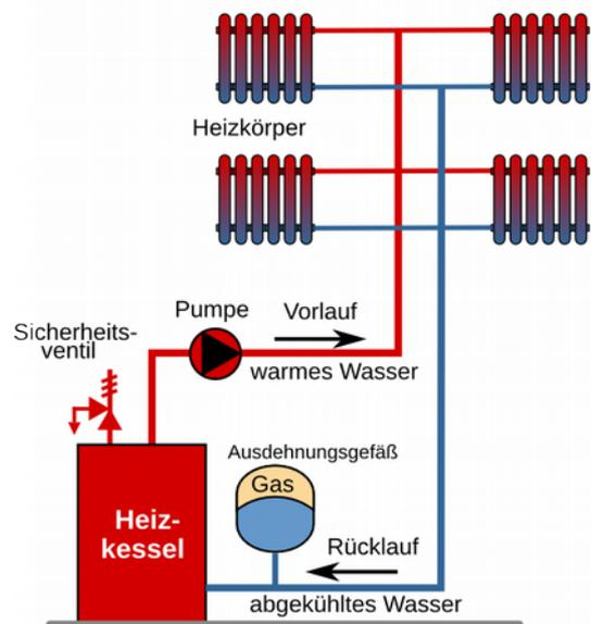
Fig. 4.24: Funktionsprinzip einer geschlossenen Heizanlage
