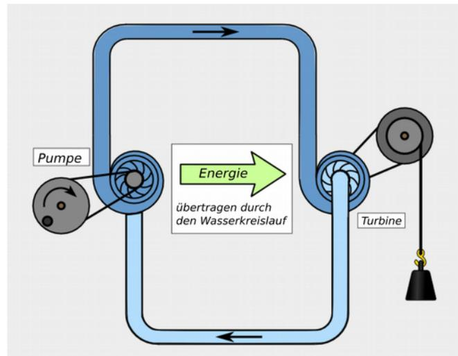
Fig. 6.5 Wassermodell des einfachen elektrischen Stromkreises
