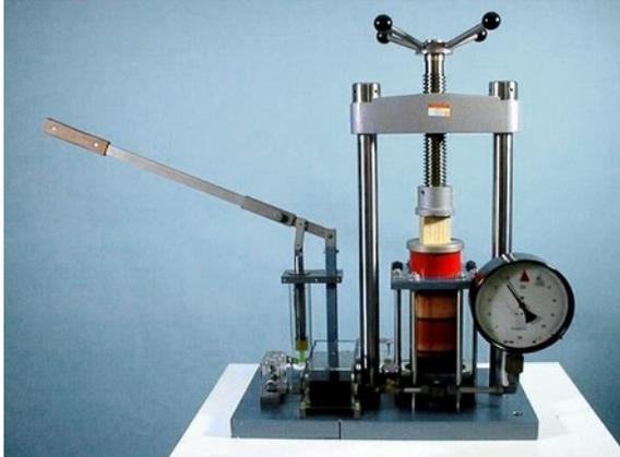
Fig. 3.20: Hydraulische Presse
