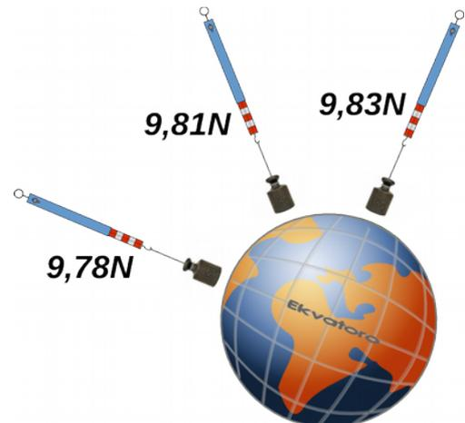
Fig. 2.13: Gewichtskraft welche auf eine Masse von  $1\text{kg}$  wirkt
