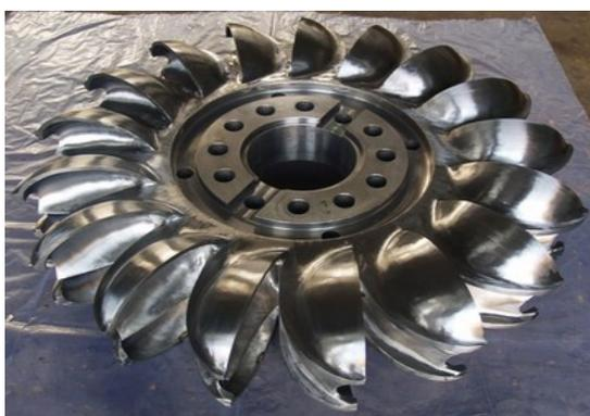
Fig. 7.8: Schaufelrad der Pelton-Turbine
