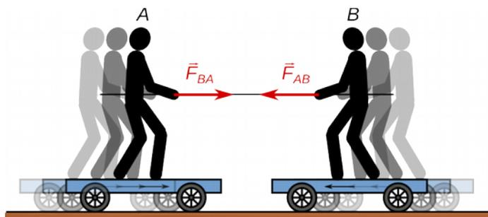
Fig. 2.4: A wirkt auf B mit derselben Kraft wie B auf A
