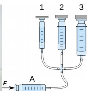
Wenn man auf den Zylinder C (Fig. 3.14), eine Kraft ausübt, dann erhöht sich der Druck im gesamten System, also auch in den Zylindern 1, 2 und 3 .
