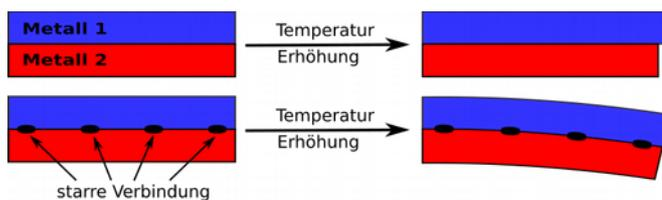
Fig. 4.17 Bimetallstreifen
