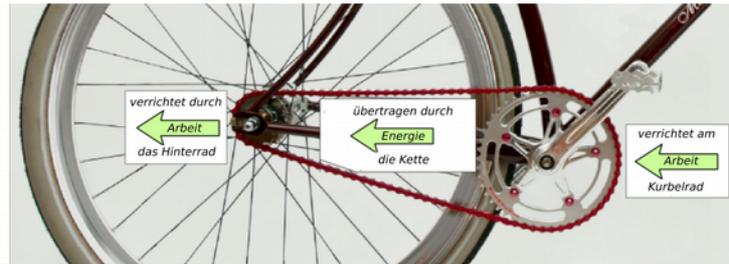
Fig. 6.6 Die Kette dreht sich und überträgt Energie
