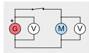
Fig. 6.14: Voltmeter im Stromkreis
