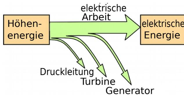
Fig. 7.12: Energieflussschema des Wasserkraftwerks
