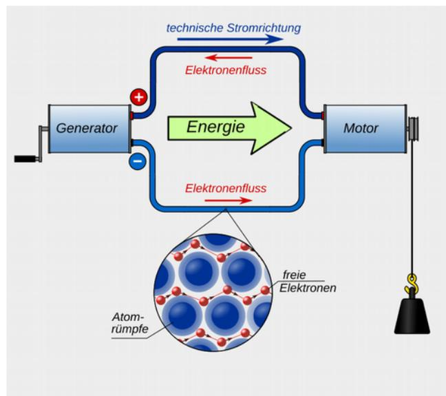
Fig. 6.7: elektrischer Stromkreis mit metallischen Leitern
