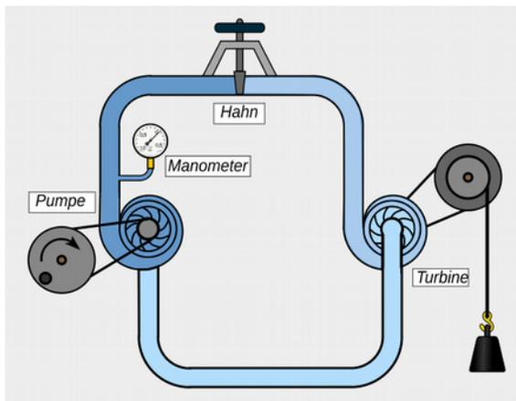
Fig. 6.12: Wasserkreislauf
