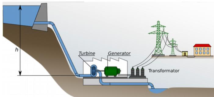
Fig. 7.2: Schema eines Wasserkraftwerkes
