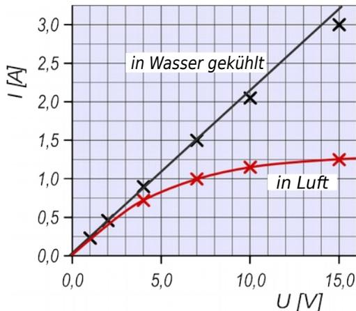
Fig. 6.31: U-I Diagramm für den Eisendraht
