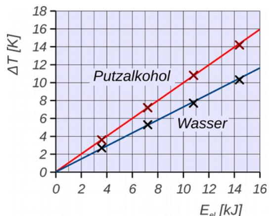
Fig. 7.19: Erwärmen von Wasser und Putzalkohol
