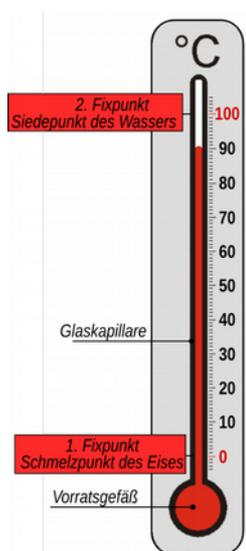
Fig. 4.10: Flüssigkeitsthermometer
