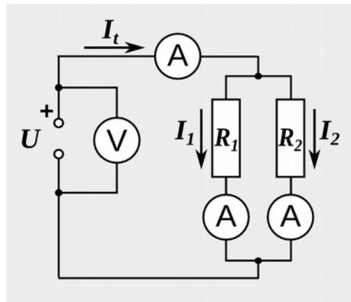
Fig. 6.23: Widerstände parallel geschaltet
