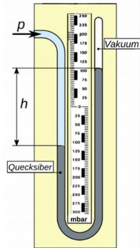
Fig. 3.32: geschlossenes U-Rohr Manometer
