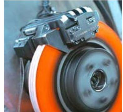
Fig. 7.15: glühende Bremsscheibe
