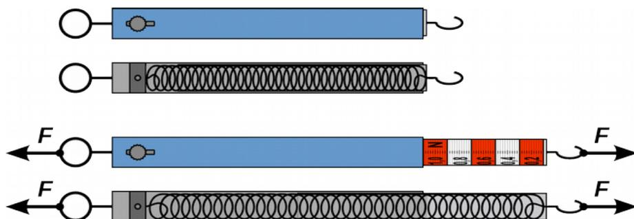
Fig. 2.1: Federkraftmesser enthalten Stahlfedern, welche sich proportional zur Kraft dehnen
