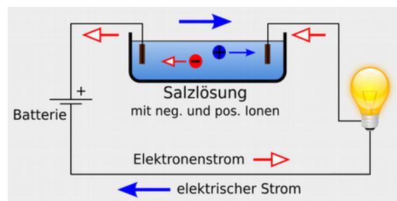
Fig. 6.8 elektrischer Stromkreis mit Elektrolyt
