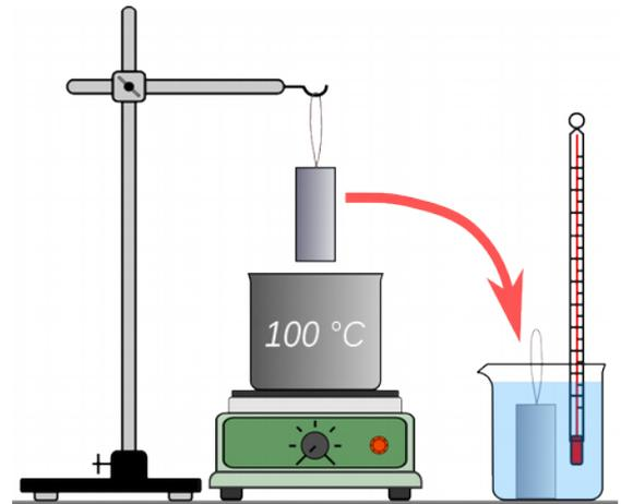
Fig. 7.20: Bestimmung der spezifischen Wärmekapazität eines Metalls
