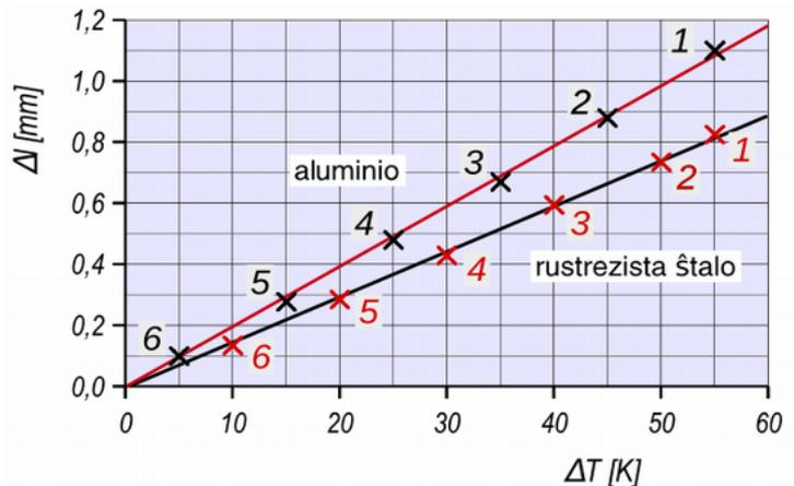
Fig. 4.14  $\Delta T$ - $\Delta l$  Diagramm für Aluminium und Inox- Stahl
