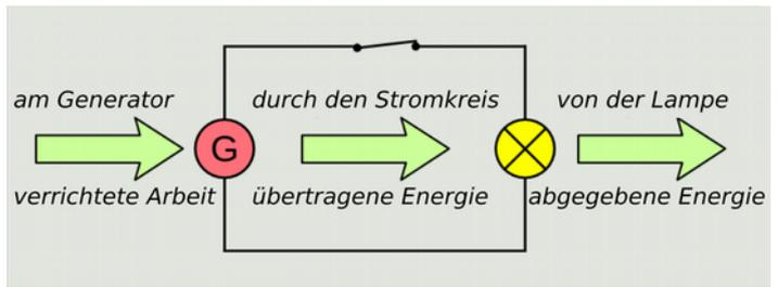
Fig. 6.1: Schema des einfachen elektrischen Stromkreises
