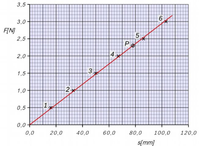
Fig. 2.7: s-F Diagramm der Stahlfeder von Fig.2.6
