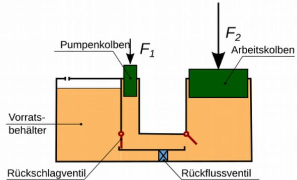
Fig. 3.21: Schema der hydraulischen Presse
