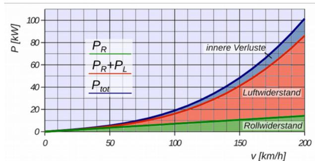
Fig. 5.42: erforderliche Leistung eines Automobils
