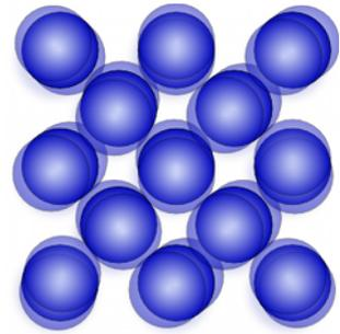
Fig. 4.9: Je höher die Temperatur ist, desto mehr vibrieren die Teilchen.
