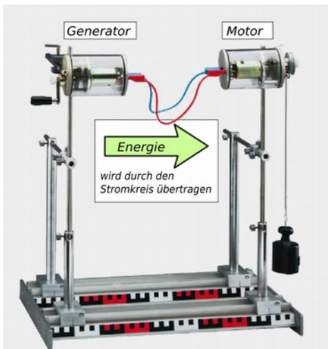
Fig. 6.4 Einfacher elektrischer Stromkreis
