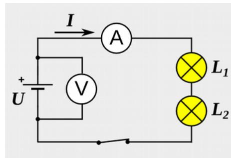
Fig. 6.33: Zwei verschiedene Lampen in Reihe
