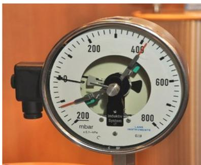
Fig. 3.18: Manometer für den Relativdruck von -200 bis +800 hPa
