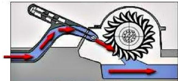
Fig. 7.7: Funktionsschema der Pelton-Turbine
