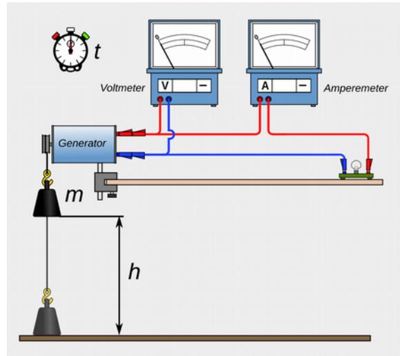
Fig. 7.4 Umwandlung von Höhenenergie in elektrische Energie
