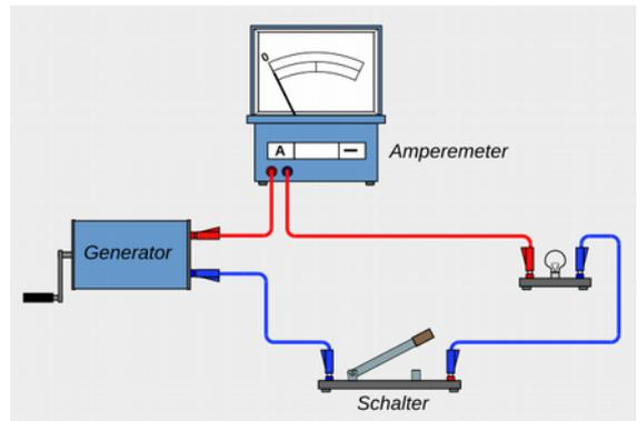
Fig. 6.10: Einfacher Stromkreis mit Amperemeter
