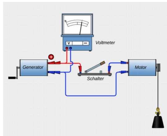
Fig. 6.13: elektrischer Stromkreis mit Voltmeter
