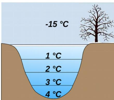
Fig. 4.23: Wasser mit 4 °C befindet sich am Seegrund und gefriert nicht
