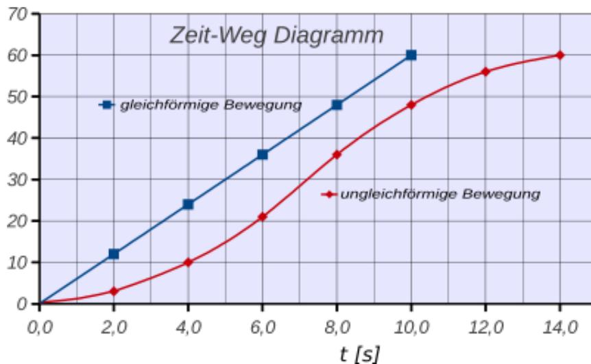
Fig. 1.13: Die blaue Gerade stellt eine Bewegung mit konstanter Geschwindigkeit dar. Die rote Kurve zeigt eine Bewegung die anfangs schneller und dann langsamer wird.
