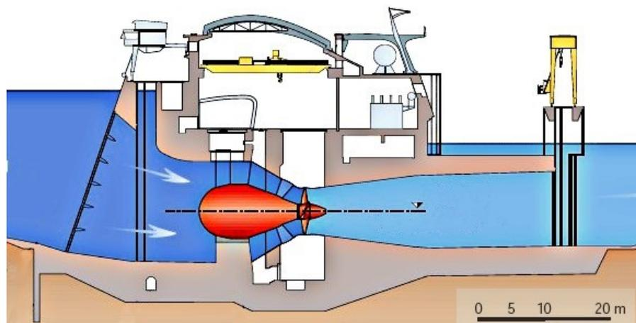
Fig. 7.10: Wasserkraftwerk mit Kaplan-Turbine an der Donau (Quelle: www.verbund.com)
