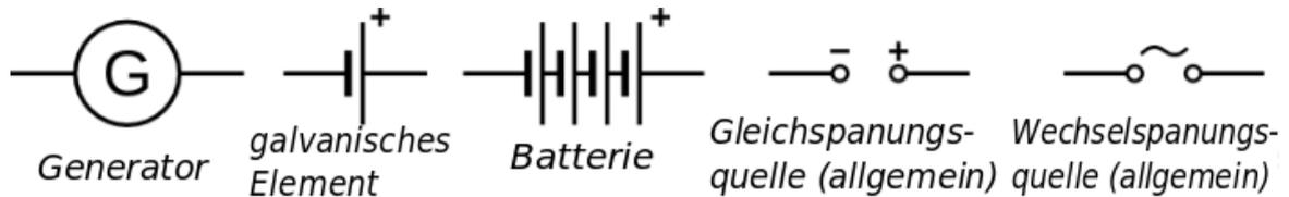
Fig. 6.15: Schema verschiedener Spannungsquellen
