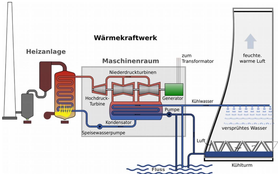
Fig. 7.13: Funktionsschema eines Wärmekraftwerks
