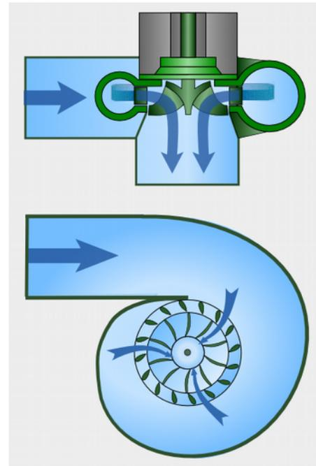
Fig. 7.9: Funktionsprinzip der Francis-Turbine
