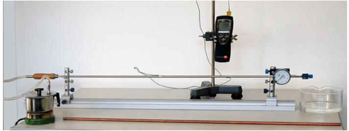
Fig. 4.13: Versuchsgerät zur Messung der linearen Ausdehnung
