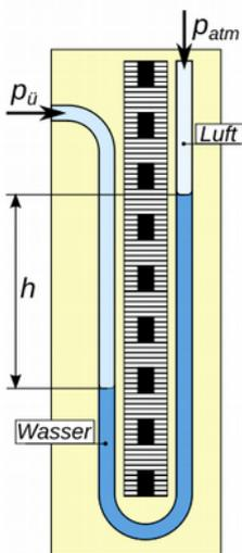
Fig. 3.31: Offenes U-Rohr Manometer
