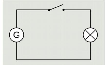
Fig. 6.3: Schalter geöffnet
