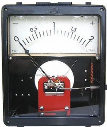
Fig. 135: Drehspulmessgerät
