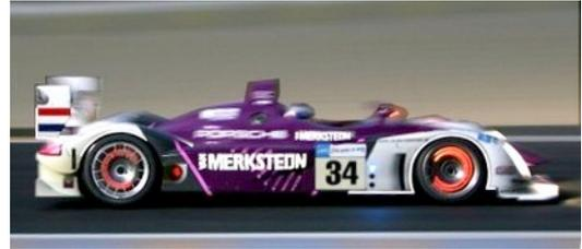
Fig. 66: Rennwagen mit glühenden Bremscheiben
